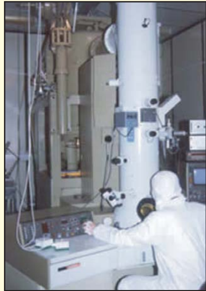
● شكل (٨) جهاز الرسم الهندسي بشعاع الإلكترونات.
